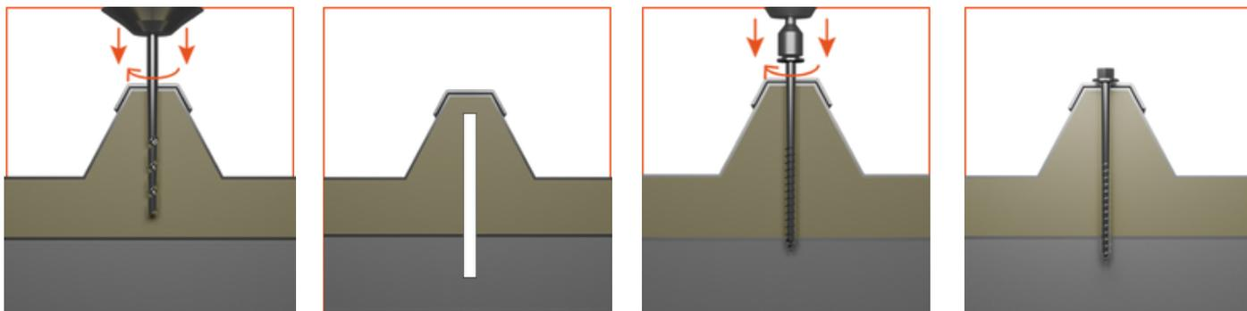
Fissaggio di lamiera grecate e ondulate su supporti metallici; è necessario il preforo.
