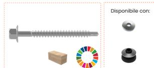
La vite per legno autoperforante a testa esagonale flangiata, è una tipologia di tirafondo idoneo anche al fissaggio su supporti in ferro, fino a ad uno spessore di 2mm. Questa vite permette di fissare pannelli metallici su supporti in legno, con una maggiore facilità e velocità di posa rispetto al tirafondo zincato non autoperforante.
