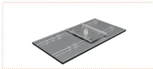
Sistema anticaduta di tipo C, da installare su lamiere aggraffate. Si tratta di un elemento in acciaio inox (AISI 304), che è certificato per numero 3 operatori. Il fissaggio alla lamiera aggraffata avviene mediante appositi morsetti in dotazione al dispositivo.
