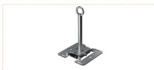
Sistema anticaduta di tipo C. Elemento in acciaio inox, può essere posizionato su un solaio in cemento armato o su una trave in cemento armato/legno/acciaio. Il prodotto è certificato per l'utilizzo contemporaneo da parte di 3 operatori. Il paletto è disponibile nelle versioni di altezza 30 cm o 50 cm.
