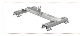
Sistema anticaduta di tipo C da installare su lamiere continue. Si tratta di un elemento in acciaio inox, che è certificato per numero 3 operatori. Il fissaggio delle diverse tipologie di lamiera continua avviene mediante appositi morsetti in dotazione al dispositivo. L'elemento RK deve essere posizionato sulla falda della copertura. L'interasse dei dispositivi è certificato per una distanza massima tra gli elementi di 15 metri.
