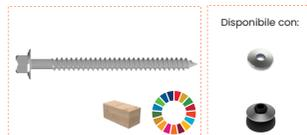
La vite per legno a testa esagonale flangiata, è un tirafondo che permette di fissare pannelli metallici su supporti in legno. Il preforo non è necessario fino a 6/10 di acciaio zincato.
