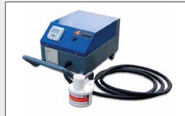
Noleggio di impianti ad induzione per il fissaggio del manto impermeabile ai dischetti in acciaio.
