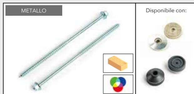
La vite per legno a testa esagonale flangiata, è un tirafondo che permette di fissare pannelli metallici su supporti in legno. Il preforo non è necessario fino a 6/10 di acciaio zincato.
