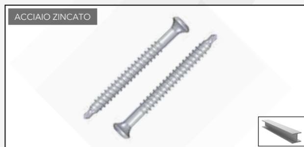
Vite diametro 4,8 mm per il fissaggio su lamiera, con punta ridotta e impronta tx. Il materiale è acciaio zincato con rivestimento Magni-Silver (15 cicli Kesternich).
