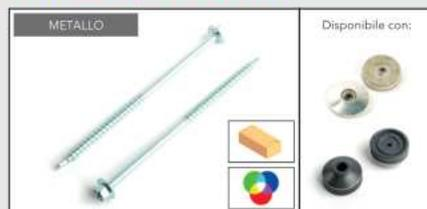
La vite per legno autoperforante a testa flangiata, è una tipologia di tirafondo idoneo anche al fissaggio su supporti in ferro, fino a ad uno spessore di 2mm. Questa vite permette di fissare pannelli metallici su supporti in legno, con una maggiore facilità e velocità di posa rispetto al tirafondo zincato non autoperforante.
