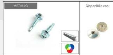
Vite autoperforante a testa esagonale flangiata, indicata per la cucitura di due lamiere fino a uno spessore di 1 mm.
