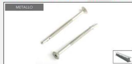
Vite autoperforante a testa svasata piana impronta tx con alette, indicata per il fissaggio di pannelli in verticale su supporti metallici oppure per il fissaggio di materiale legnoso su supporti metallici.
