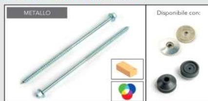
La vite per legno a testa esagonale flangiata, è un tirafondo che permette di fissare pannelli metallici su supporti in legno. Il preforo non è necessario fino a 6/10 di acciaio zincato.
