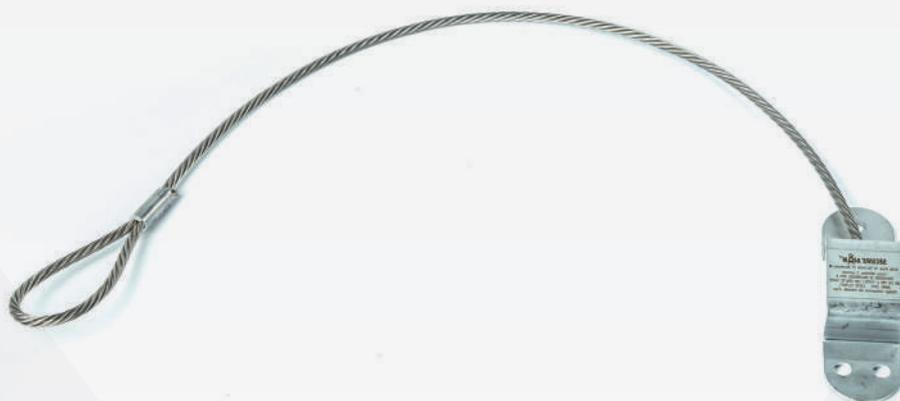
Sistema anticaduta di tipo A, elemento di ancoraggio unidirezionale, costituito da una piastra in acciaio inox nella quale è inserita una fune in acciaio inox di diametro 6 mm, formazione 7x19 (133 fili) lunga 70 cm. Il prodotto è certificato per l'utilizzo contemporaneo da parte di 2 operatori. Il punto di ancoraggio, una volta installato, deve essere rivolto verso la direzione di applicazione del carico. Il fissaggio deve avvenire in corrispondenza della struttura portante.
