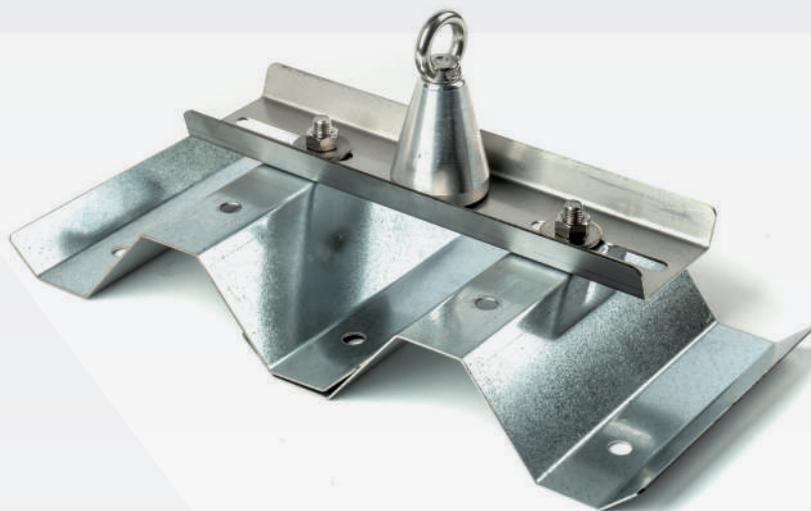
Sistema anticaduta di tipo A, da installare su coperture ondulate e fibrocemento ecologico. Elemento di ancoraggio unidirezionale, in acciaio inox (AISI 304), certificato per numero 2 operatori. Il fissaggio avviene in corrispondenza della struttura portante.
