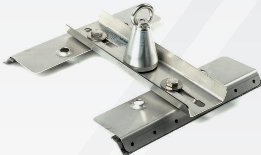
Sistema anticaduta di tipo A, da installare su lamiere grecate o pannelli sandwich. Si tratta di un elemento di ancoraggio unidirezionale, in acciaio inox (AISI 304 ) e certificato per 2 operatori. Il fissaggio avviene mediante rivetti certificati in dotazione al dispositivo.
