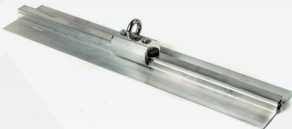
GANCIO ITAL-EG: sistema anticaduta di tipo A, da installare su lamiere grecate o pannelli sandwich. Il dispositivo di ancoraggio è in alluminio, bidirezionale, e certificato per 1 operatore. È adatto a coperture in lamiera, pannello sandwich con spessore fino a 4/10, strutture in cemento, in ferro e legno. Il dispositivo su richiesta può essere fornito colorato bianco grigio, rosso siena, testa di moro o anodizzato.
