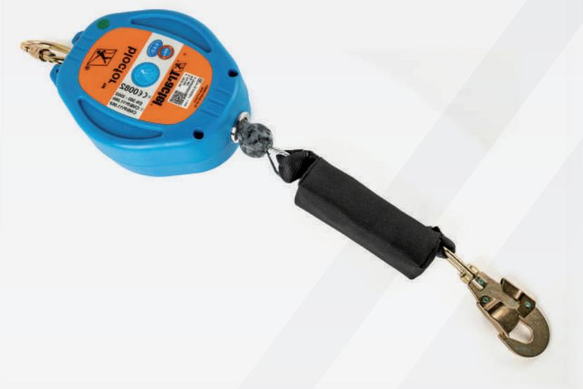
Dispositivo anticaduta a riavvolgimento automatico con assorbitore di energia per uso verticale ed orizzontale certificato secondo la EN 360 con fune metallica e moschettone girevole.
