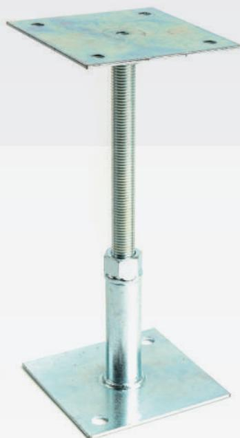
Il piedino di sostegno regolabile in altezza è fornito con barra filettata M16. Utilizzato per variazioni di pendenza per coperture piane, su di esso è possibile l'applicazione di listelli in legno e sostegni metallici (es. omega). La saldatura avviene in acciaio basso legato. I supporti regolabili sono composti da due componenti da avvitarsi l'uno dentro l'altro e bloccati dal dado. Il prodotto è offerto con una parte superiore costituita da una piastra di tipo piano a L.
