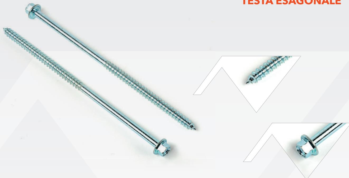
La vite per legno a testa esagonale, è un tirafondo che permette di fissare pannelli metallici su supporti in legno. Il preforo non è necessario fino a 6/10 di acciaio zincato.
