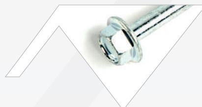
Vite a testa esagonale autofilettante a passo universale, idonea al fissaggio su supporti in legno, ferro zincato o alluminio. È necessario il preforo con punta da 5,8 in caso di fissaggio su profilato metallico.
