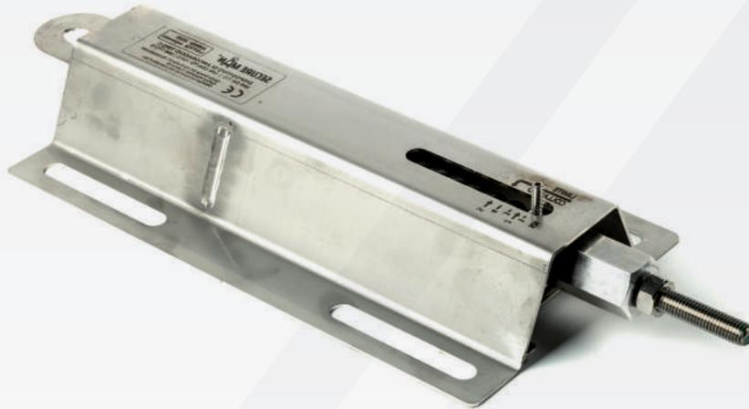
**SLIDE PIANO:** sistema anticaduta di tipo C, da installare su copertura piana o superficie inclinata. Elemento in acciaio inox (AISI 304) certificato per numero 3 operatori, il dispositivo è dotato di assorbitore e tenditore integrati. Il fissaggio avviene in corrispondenza della struttura sottostante. L'interasse dei dispositivi è certificato per una distanza massima tra gli elementi di 15 metri.
