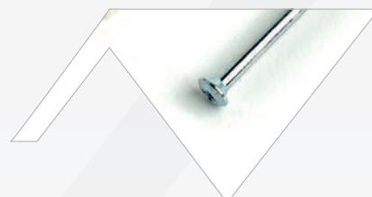
Il tassello a battere è caratterizzato da un corpo in nylon bianco a rapida espansione e testa svasata, con vite in acciaio zincato, taglio pozidrive per lo smontaggio dall'ancoraggio al muro. È consigliato per il fissaggio nella pietra naturale, nel cemento e mattoni. Il corpo è in poliammide PA6 mentre la vite taglio pozidrive è zincata galvanica 5µm. La temperatura di utilizzo va dai -40° ai +80°.
