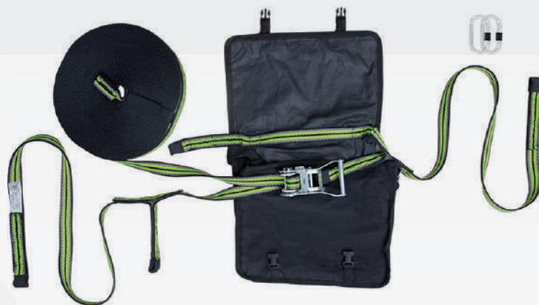
Linea vita provvisoria di tipo B certificata secondo la normativa EN 795 realizzata in nastro sintetico regolabile. Lunghezza massima 20 m, utilizzabile da n° 2 operatori e completa di sacca.
