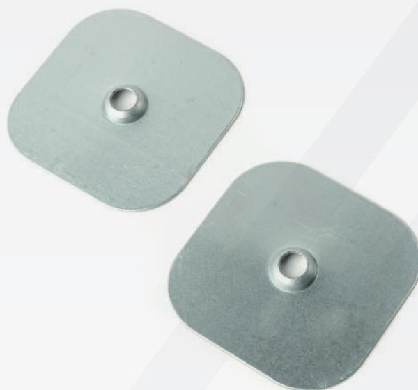
Gesa offre una serie completa di piastre quadre e ovali in acciaio zincato per coperture. Le piastre sono adatte per il fissaggio di materiali isolanti sulle coperture di tetti civili e industriali. La gamma presenta diverse tipologie di imbutiture per i vari utilizzi e il diametro dei fori diversificato, in base al fissaggio da utilizzare.
