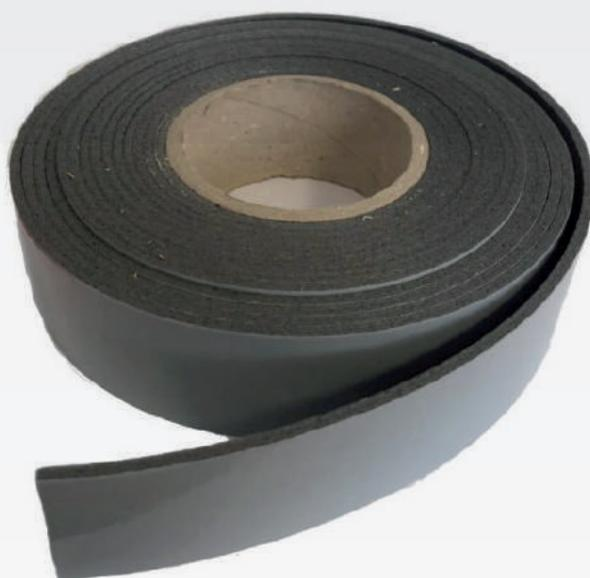
Bandella dielettrica in espansolene da interporre tra coperture in alluminio e supporti metallici in ferro e, in tutti gli altri casi per evitare effetti di corrosione galvanica.
