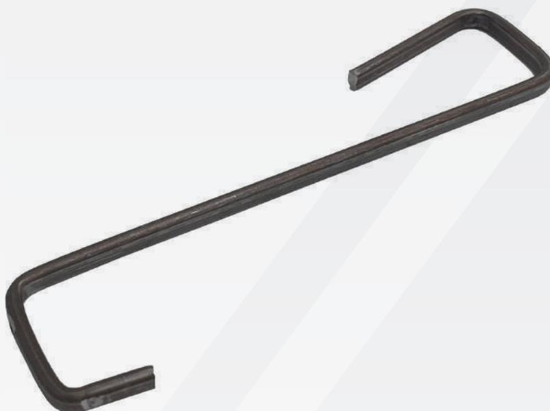
I ganci fermacoppi sono dei prodotti che assicurano una grande stabilità alla copertura; sono degli importanti elementi di fissaggio che permettendo di eliminare la malta dei coppi, riducono il peso complessivo che grava sul tetto e favoriscono la microventilazione.
