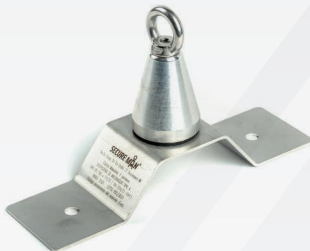
Elemento di ancoraggio unidirezionale, in acciaio inox (AISI 304) certificato per 2 operatori. I dispositivi possono essere installati in verticale e/o orizzontale in corrispondenza di strutture in cemento, acciaio e legno.
