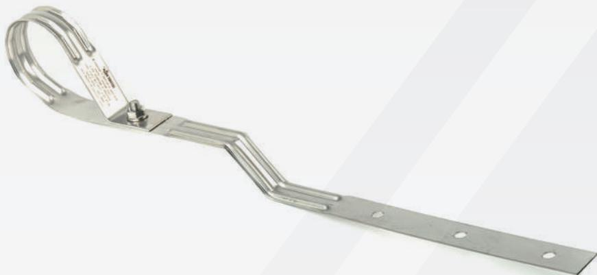
Sistema anticaduta di tipo A, da installare su coperture in laterizio. Elemento di ancoraggio unidirezionale, in acciaio inox preverniciato, certificato per numero 2 operatori. Il punto di ancoraggio una volta installato deve essere rivolto verso la direzione di applicazione del calco. Il fissaggio avviene in corrispondenza della struttura portante.
