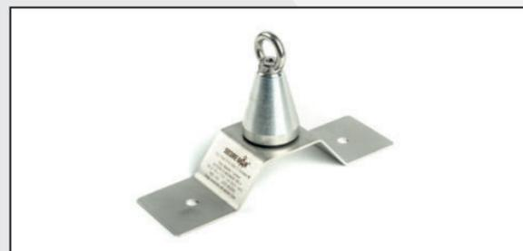
Elemento di ancoraggio unidirezionale, in acciaio inox (AISI 304) certificato per numero 2 operatori. I dispositivi possono essere installati in verticale e/o orizzontale in corrispondenza di strutture in cemento, acciaio e legno.
