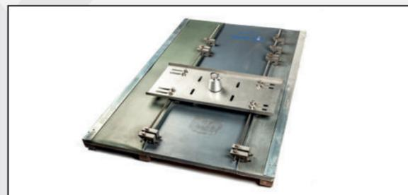
Sistema anticaduta di tipo C, da installare su lamiere aggraffate. Si tratta di un elemento in acciaio inox (AISI 304), che è certificato per numero 3 operatori. Il fissaggio alla lamiera aggraffata avviene mediante appositi morsetti in dotazione al dispositivo.
