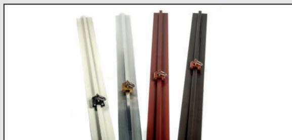
Sistema anticaduta di tipo D, da installare su coperture piane o superfici inclinate. E' composto da una serie di elementi dal cui assemblaggio si ottiene una linea di ancoraggio rigida. Il binario è in alluminio, su cui scorre un carrello certificato per due operatori.
