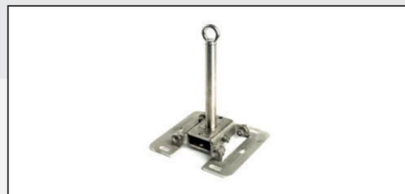
Sistema anticaduta di tipo C. Elemento in acciaio inox, può essere posizionato su un solaio in cemento armato o su una trave in cemento armato/legno/acciaio. Il prodotto è certificato per l'utilizzo contemporaneo da parte di 3 operatori. Il paletto è disponibile nelle versioni di altezza 30 cm o 50 cm.
