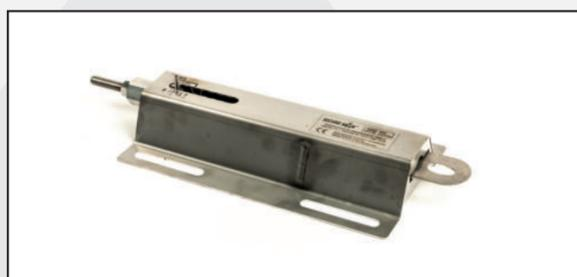
Sistema anticaduta di tipo C, da installare su lamiere grecate o pannelli sandwich. E' un elemento in acciaio inox (AISI 304), certificato per 3 operatori e dotato di assorbitore e tenditore interni all'elemento.
