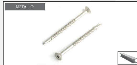
Vite autoperforante a testa svasata piana impronta tx con alette, indicata per il fissaggio di pannelli in verticale su supporti metallici oppure per il fissaggio di materiale legnoso su supporti metallici.
