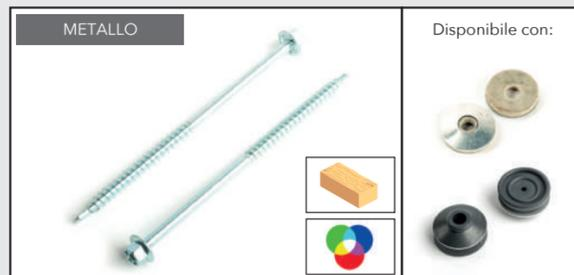
La vite per legno autoperforante a testa flangiata, è una tipologia di tirafondo idoneo anche al fissaggio su supporti in ferro, fino a ad uno spessore di 2mm. Questa vite permette di fissare pannelli metallici su supporti in legno, con una maggiore facilità e velocità di posa rispetto al tirafondo zincato non autoperforante.
