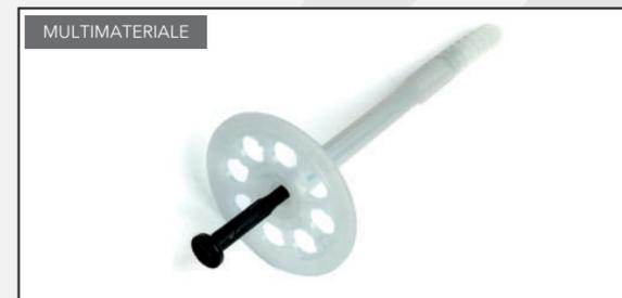
Il tassello è utilizzato per la messa in opera degli isolamenti detti comunemente a cappotto. Il fissaggio consiste in un tassello in PEHD mentre, per quanto riguarda il perno, presentiamo due versioni: in fibra di vetro o in acciaio.
