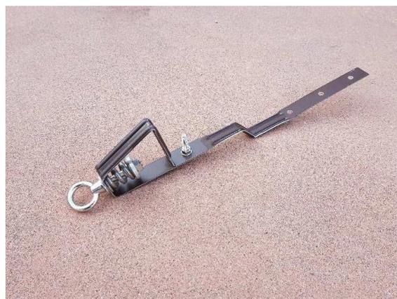
Configurazione delle prove: Ancoraggi fissati a struttura di prova in acciaio mediante 1 bullone M10 classe 8.8
