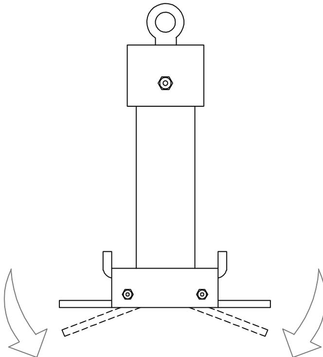
L'elemento STR è dotato di ali che permettono al dispositivo di adattarsi ag ogni tipo di superficie
