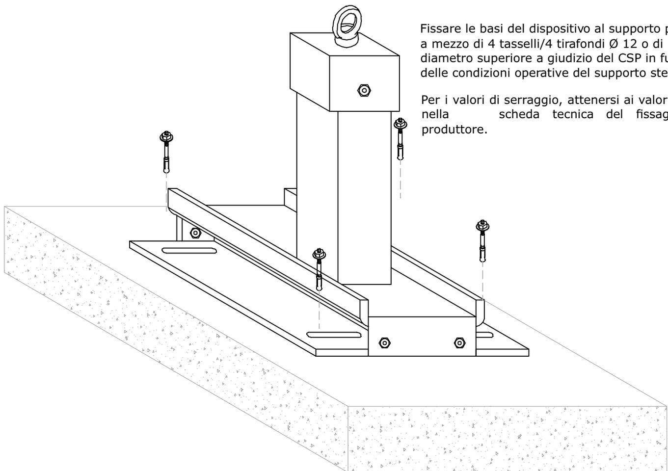
Fissare le basi del dispositivo al supporto portante a mezzo di 4 tasselli/4 tirafondi  $\varnothing 12$  o di diametro superiore a giudizio del CSP in funzione delle condizioni operative del supporto stesso.
