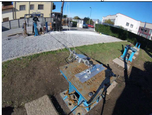
Prova di resistenza dinamica e di integrità Ortagonale lato lungo
