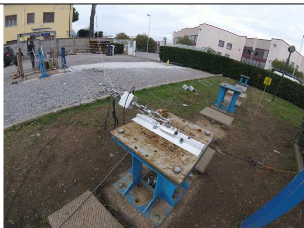
Prova di resistenza dinamica e di integrità Ortagonale lato corto
