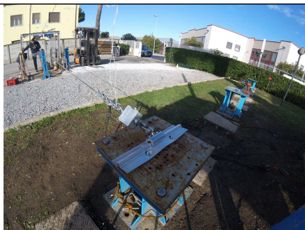
Prova di resistenza dinamica e di integrità Ortagonale lato lungo
