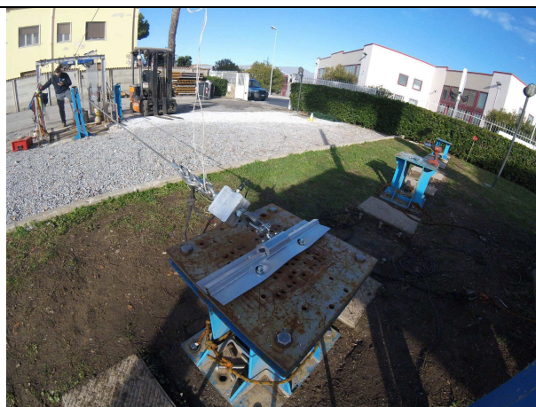
Prova di resistenza dinamica e di integrità Ortagonale lato lungo
